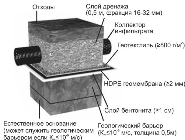
Рисунок 1. Конструкция основания полигона
